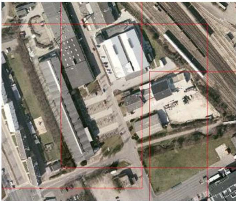
Nærbillede af overlapsområde af fire ortofotos uden fastlagte sømlinjer (seamlines). De røde linjer viser afgrænsningen af de enkelte ortofotos.
