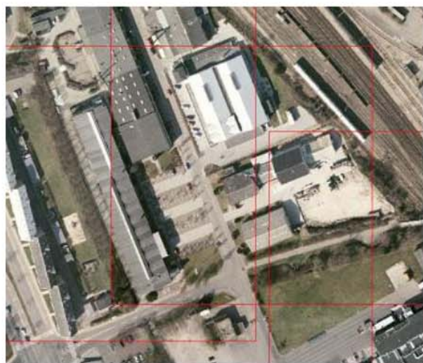
Figur 3.24. Nærbillede af overlaps-område af fire ortofotos uden fastlagte sømlinjer. De røde linjer viser afgrænsningen af de enkelte ortofotos.
