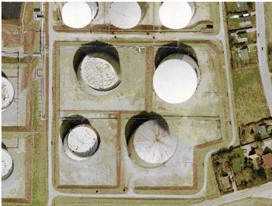
Fejl i automatisk genereret sømlinje
